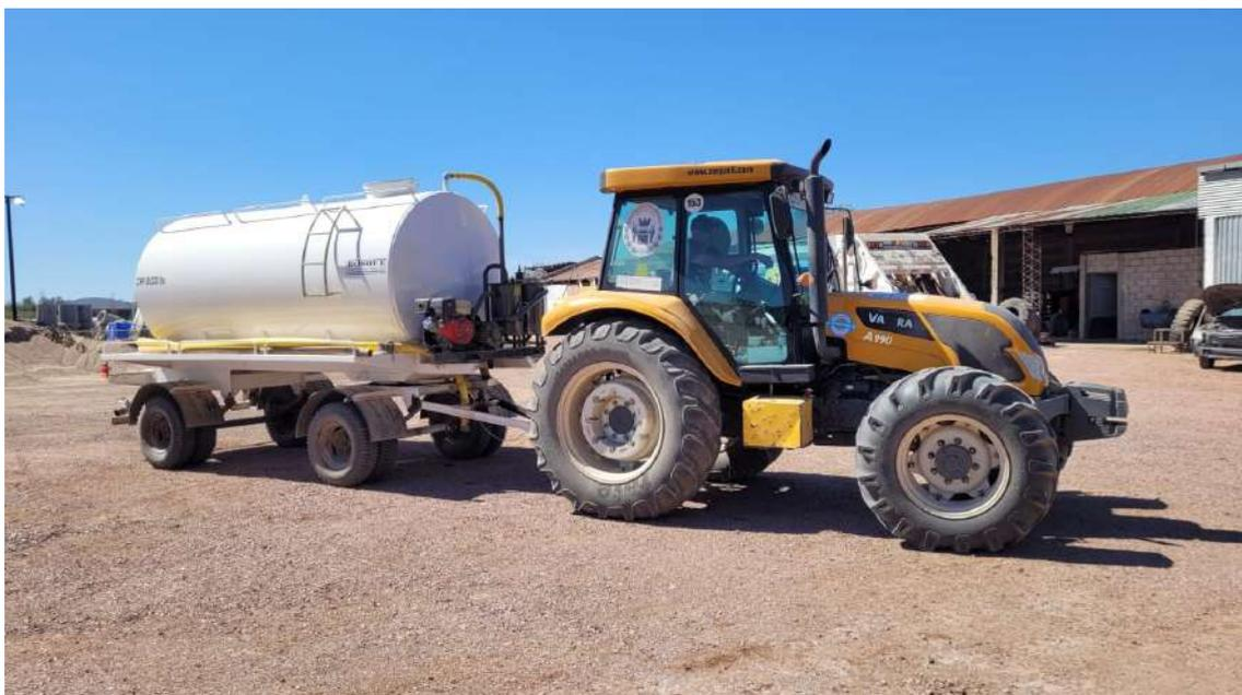
*Figuras 93 - Tanque atmosférico de arrastre*
